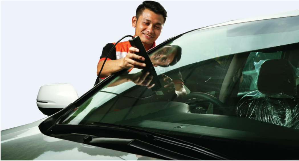
Kapsyen: Pemeriksa kenderaan PUSPAKOM menggunakan peralatan untuk ujian ketelusan cermin.
