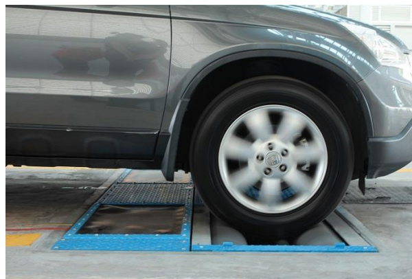
Kapsyen: Pemeriksaan brek dijalankan menggunakan peralatan pemeriksaan berkomputer.
